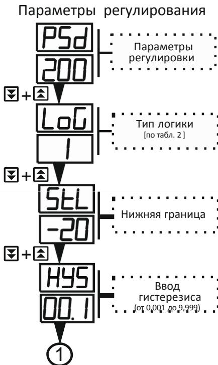
Параметр “Тип логики работы прибора” определяет алгоритм управления исполнительным устройством (см. рисунок 6).
