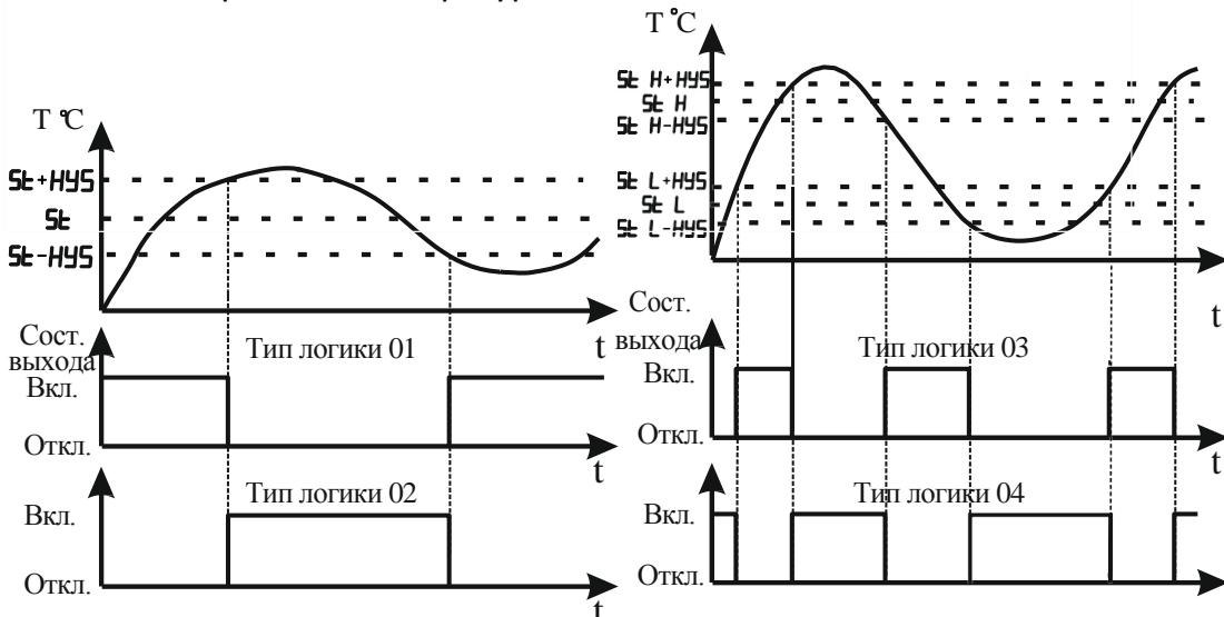
**Рисунок 6 – Графическое представление типов логики работы выхода**
